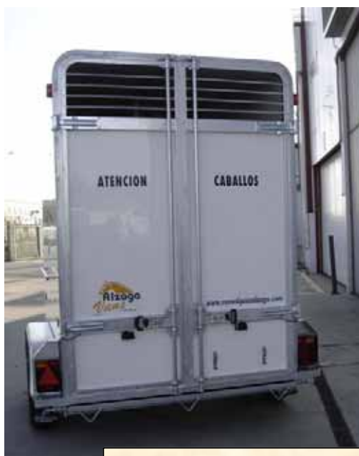
⇒Trasera con cierre individual en cada puerta y rampa escamoteable.
